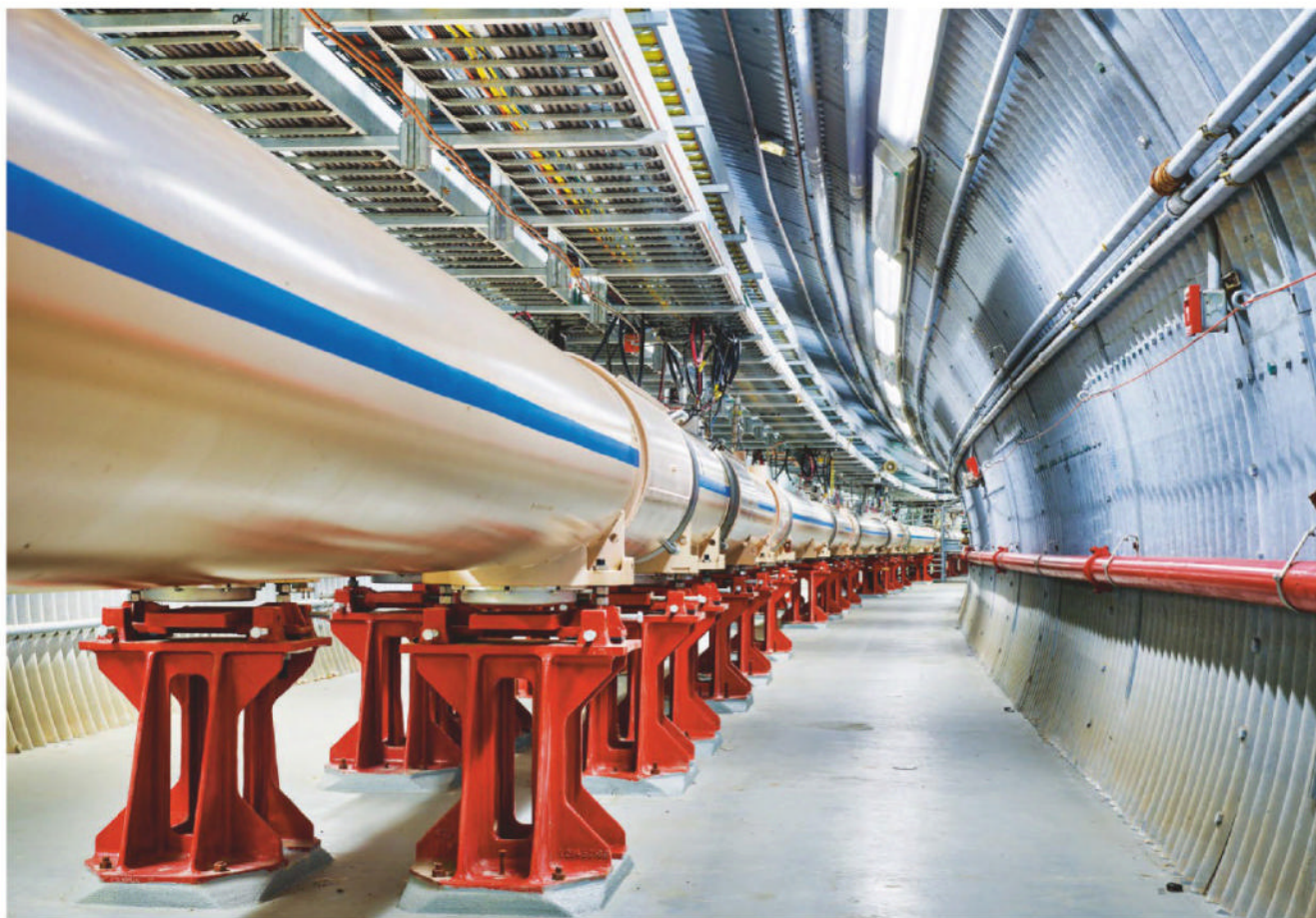
粒子以接近光速的速度在 RHIC 周长约为 3.86 千米的环中循环飞行，然后在 sPHENIX 等探测器里碰撞。
