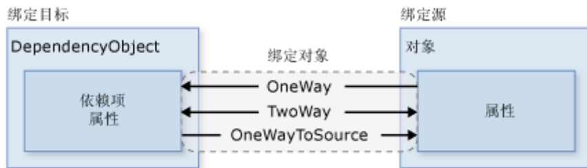
图 4-9 数据绑定后的三种数据流向 [35]
